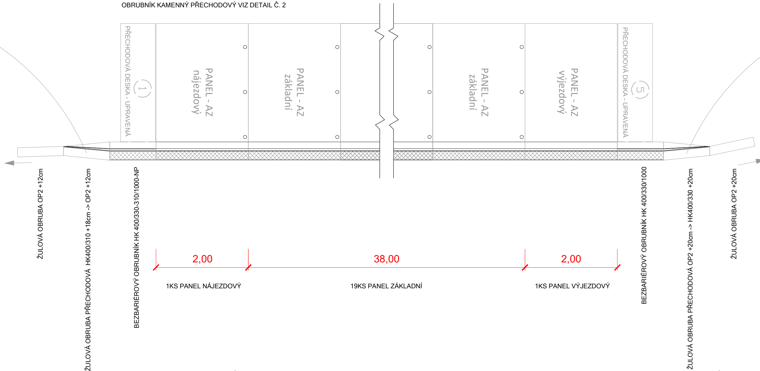
KLADECÍ SCHEMA ZASTÁVKOVÝCH PANELŮ:
